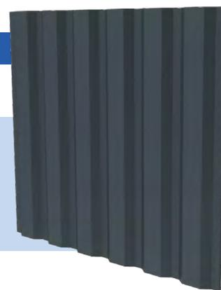
**25-180-1085** est une plaque de bardage à plages lisses conçue pour la pose avec nervures horizontales et bien sûr aussi verticales. Les fixations sont logées en fonds de nervures. En pose horizontale double peau, JI25-180-1085 s'appuie sur des écarteurs distants au maximum de deux mètres. La laque définie à lacommande de JI 25-180-1085 est appliquée en face CO.
