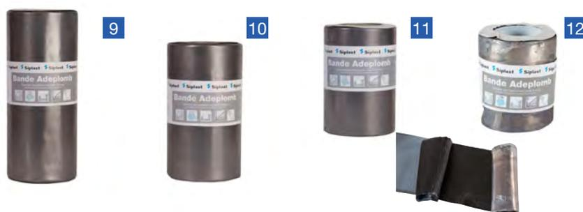
RESISTIT G SK est une bande d'étanchéité autoadhésive avec une couche supérieure en caoutchouc EPDM armé d'une épaisseur totale de 1,6 mm. RESISTIT G SK convient pour l'étanchéité des châssis, des seuils, des éléments de façade, des fondations et des murs de cave. Pour l'industrie des façades, c'est le produit idéal comme bande de couverture et une alternative au plomb.
